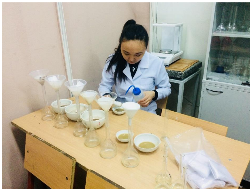
4 Сурет – P_2O_5 цитратты ерігіштігін анықтау барысы
