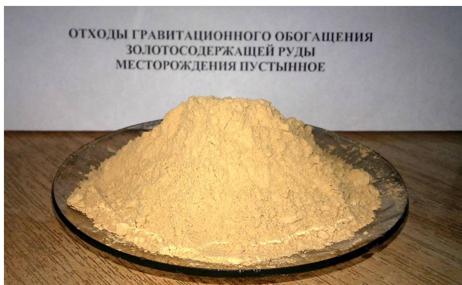
2 Сурет – Пустынное кен орнының құрамында алтын сульфиді бар гравитациялық байыту қалдығы
